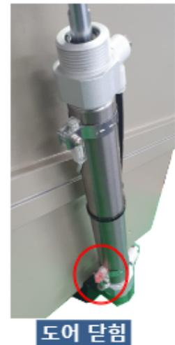
Figure 4-4 도어 OPEN/CLOSE 센서 위치
