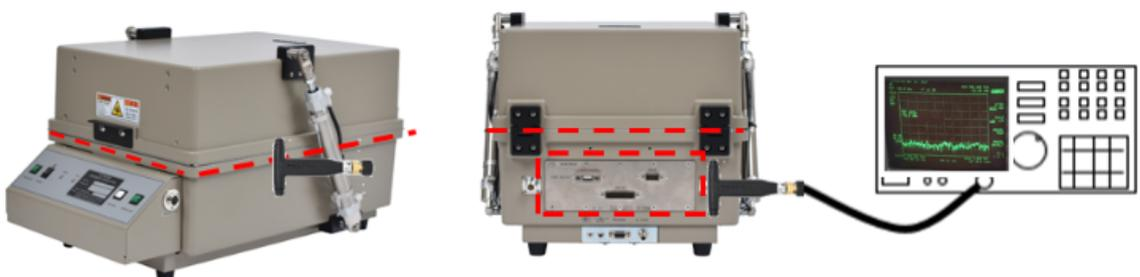
Figure 6-4 최대 누설치 측정 (예, 값 : -90 dBm)
