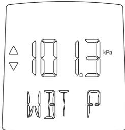
Mit der mittleren Taste (4) ändern Sie den Wert bzw. entsperren/sperrern den Menüpunkt »WBT P« gegen Änderung.
