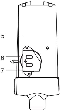
**Beugen Sie durch geeignete Vorsichtsmaßnahmen wie z. B. durch ein geerdetes Handgelenkband elektrostatischen Entladungen während des Batteriewechsels vor! Elektrostatische Entladungen können das Gerät zerstören!**
