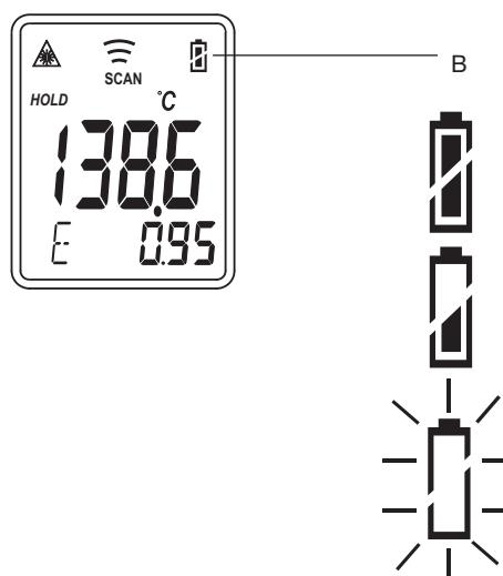
Die Anzeige des Batteriesymbols weist auf den Zustand der Batterie hin (B).
