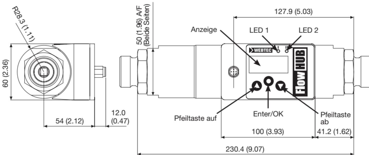
Nach Einschalten der Einheit wird zuerst die Software Version für ca. 3 Sekunden angezeigt, dann leuchten die LEDs kurz auf, Fehlermeldungen werden angezeigt, dann die aktuelle Durchflussmenge. Von diesem Zeitpunkt an kann auf das Menü, wie unten beschrieben, zugegriffen werden.
