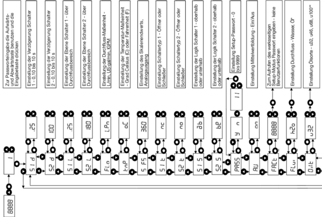
Zum Eingeben der Setup-Ebene müssen Sie die Freigabetaste und gleichzeitig die Aufwärtstaste drücken und zwei Sekunden lang halten.
